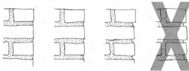
Figure 2: Exemples de quelques profils de joints
