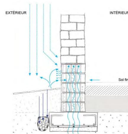
Figure 18: Fondation béton armé, soubassement briques isolantes, drain : gravier + géotextile, sol : hérissos, géotextile, pierres sur lit de sable
