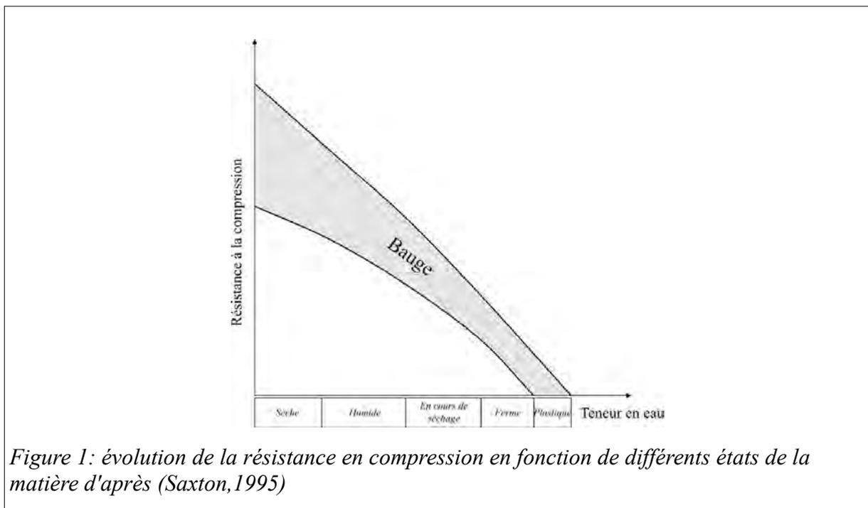
Figure 1: évolution de la résistance en compression en fonction de différents états de la matière d'après (Saxton, 1995)
