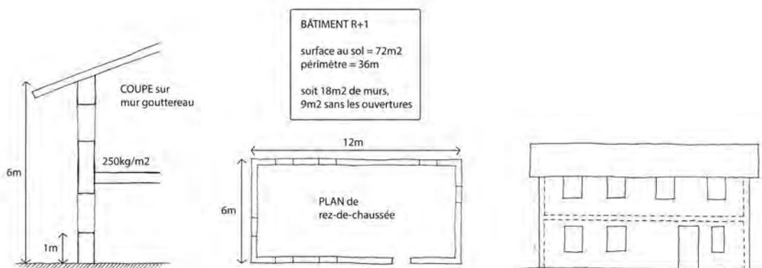
Soit un bâtiment en R+1, c'est-à-dire 6 m de hauteur et de 12 x 6 m d'emprise au sol (périmètre = 36 m, surface = 72 m<sup>2</sup>) avec des murs de 50 cm d'épaisseur et 30 % d'ouvertures à partir de 1 m du sol. Charge du poids propre de la terre : 1m<sup>3</sup> de pisé = 2 tonnes, soit 2000 kg.
