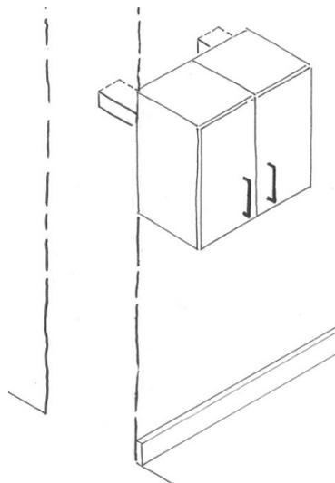
Figure 27: Fixation sur élément rapporté (briques cuites)
