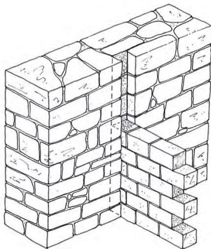
Figure 23: exemple jonction briques / mur en pierre
