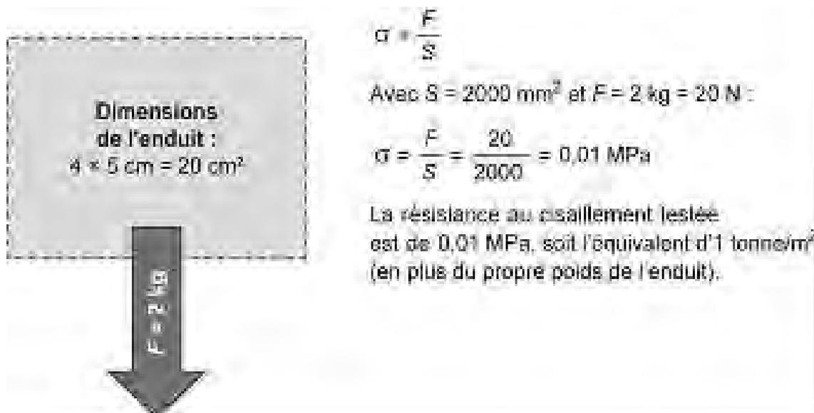
**Figure 5 : Note de calcul de l'essai de charge, d'après les Règles Professionnelles de la construction paille**
