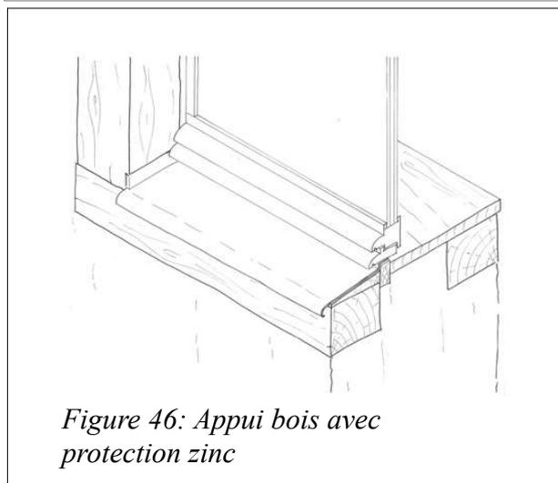
Figure 46: Appui bois avec protection zinc
