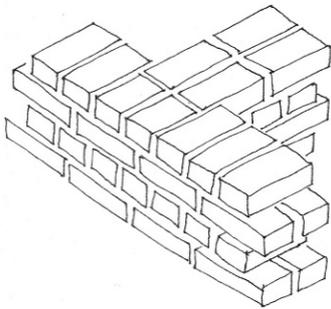
En plus des contraintes esthétiques du parement soigné, le profil des joints ne doit pas s'opposer à l'écoulement des eaux de ruissellement et ne pas avoir de trous qui laisseraient entrer l'eau de ruissellement à l'intérieur du mur.
