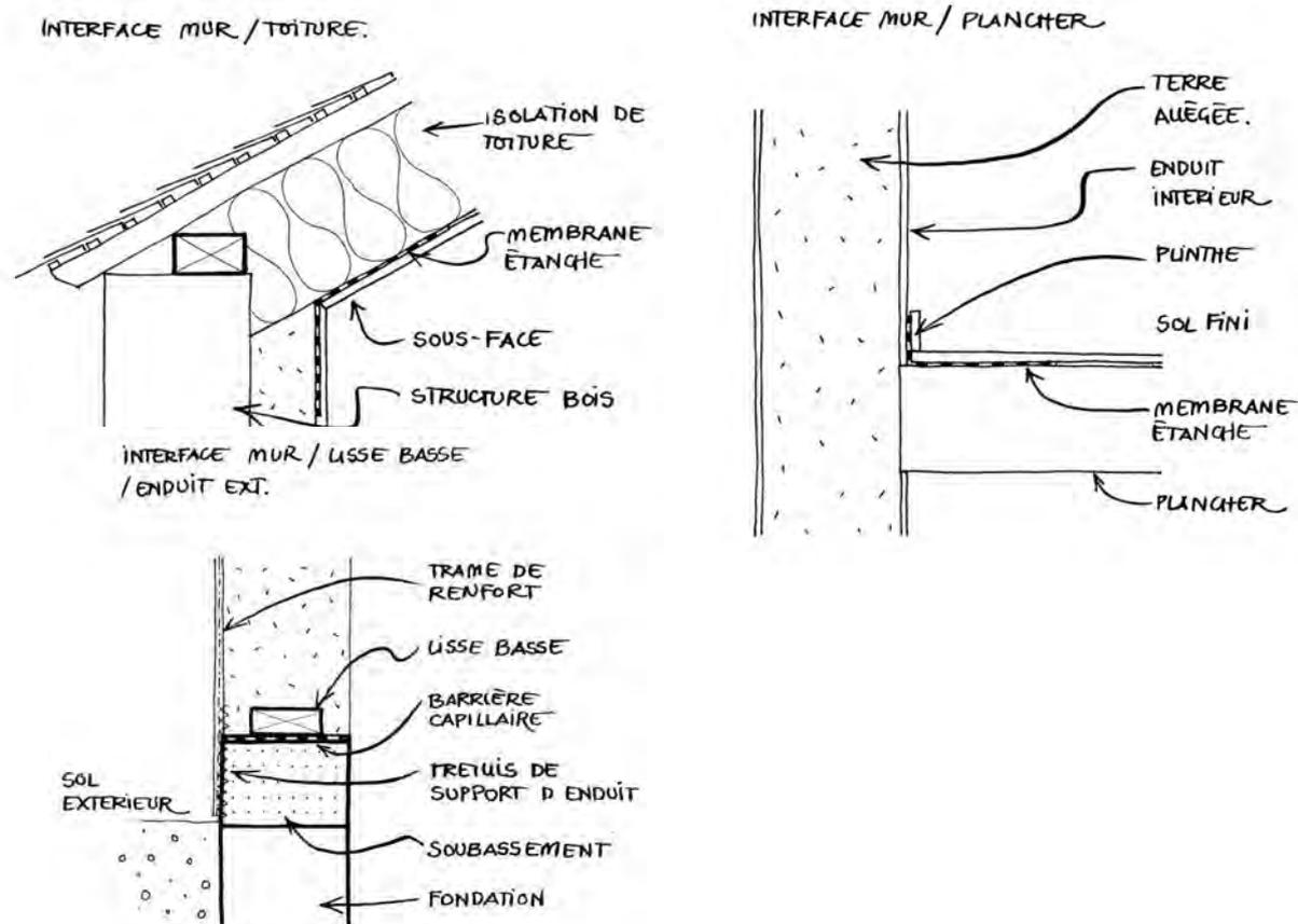
Fig. 6 : Points singuliers de l'étanchéité à l'air
