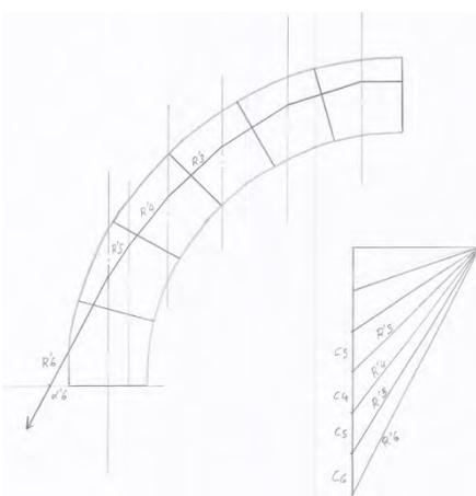
Figure 38: Détermination graphique de la ligne de pression
