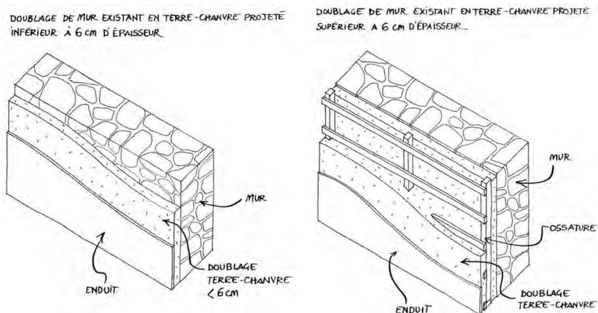
Figure 5: Illustrations des 2 principales techniques de projection de terre-chaivre
