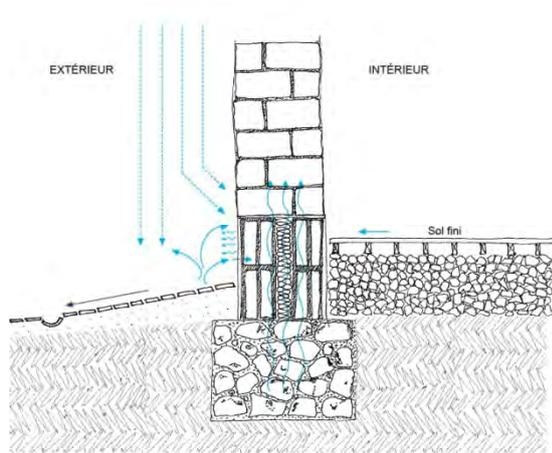
Figure 16: Fondation béton cyclopéen, soubassement blocs isolés, canal de drainage en pierre, plancher sur hérissos
