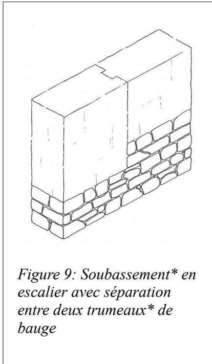
*Figure 9: Soubassement\* en escalier avec séparation entre deux trumeaux\* de bauge*
