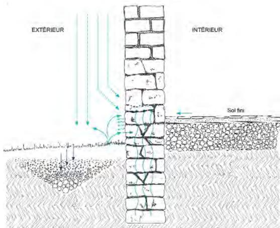
Figure 15: Fondation-soubassement en pierres maçonnées, drain enterré, tomettes sur dalle chaux et hérissos
