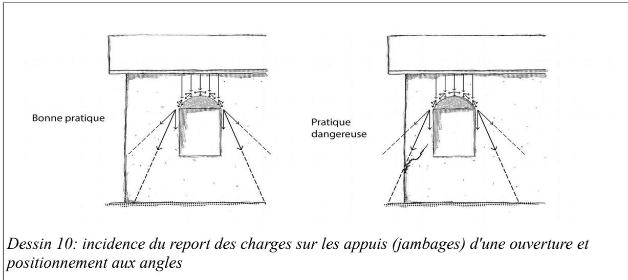
Dessin 10: incidence du report des charges sur les appuis (jambages) d'une ouverture et positionnement aux angles
