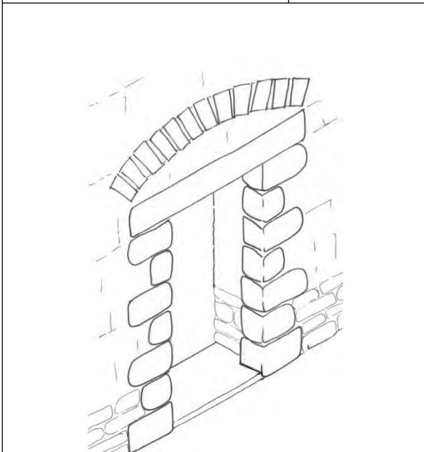
Figure 44: Encadrement en pierres avec arc de décharge\*
