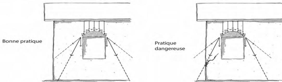
Figure 30: Incidence du report des charges\* sur les appuis d'une ouverture et positionnement aux angles
