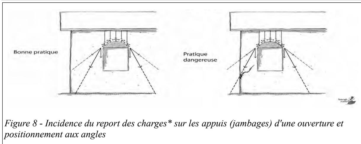
Figure 8 - Incidence du report des charges\* sur les appuis (jambages) d'une ouverture et positionnement aux angles
