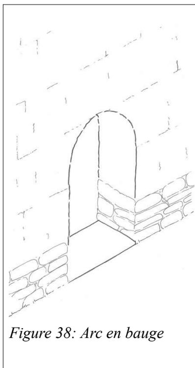
Figure 38: Arc en bauge
