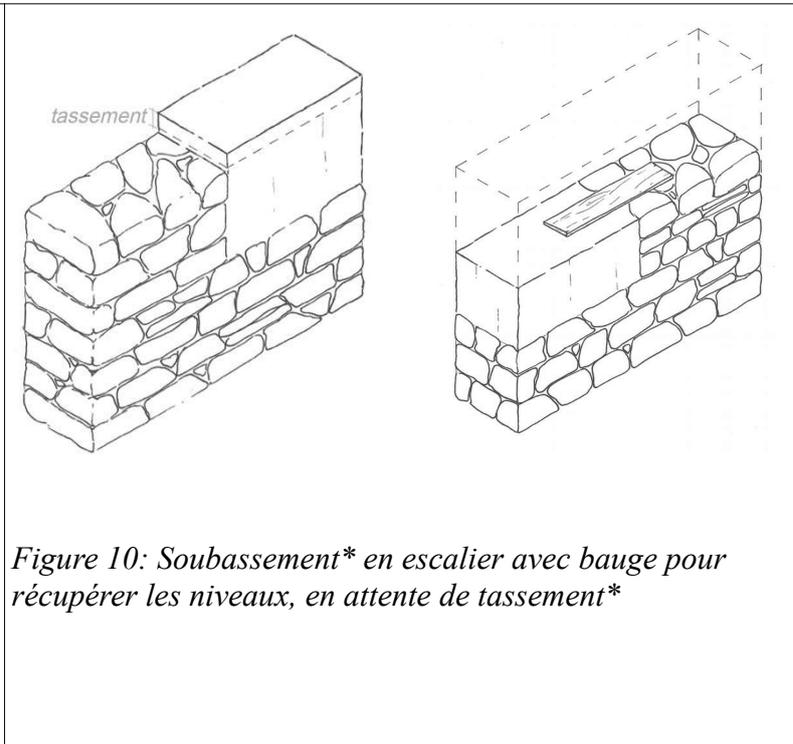
*Figure 10: Soubassement\* en escalier avec bauge pour récupérer les niveaux, en attente de tassement\**
