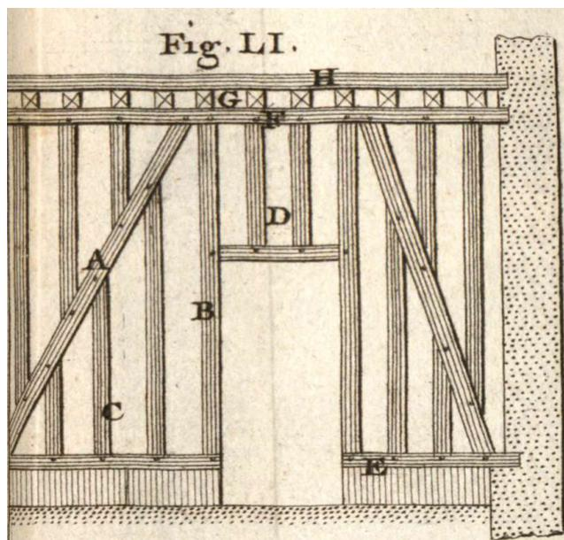
Fig. 1: A: écharpe ou décharge (contreventement\*) / B: Poteau, poteau d' huisserie / C: Tournisse / D: Potelet / E: sablière basse, lisse basse ou sole. Repose sur un solin (muret) / F: sablière haute ou lisse haute / G: solives / H: sablière chambrée. Extrait de J.-F. Blondel et continué par P. Patte, Cours d'architecture, Planches t.6, Desaint, 1777.
