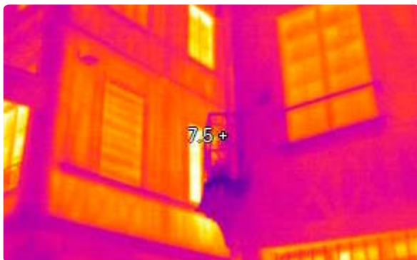
Mise en évidence d'un colombage caché (projet FaHeBA Rouen 2015)
