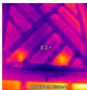
Mise en évidence de ponts thermiques (tâches orangées), non représentatif de la structure de la paroi. (Paris 2015 projet FaHeBA)
