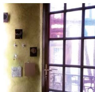
Mesures des températures de rayonnement réfléchi et d'air en intérieur et en extérieur (Rouen 2015 projet FaHeBA)
