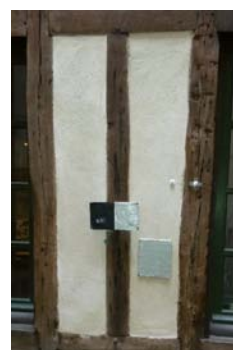
Mesures température de rayonnement réfléchi et d'air (Paris 2016 projet FaHeBA)
