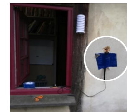
Sondes de mesure de température et humidité relative placées en face intérieure du mur
