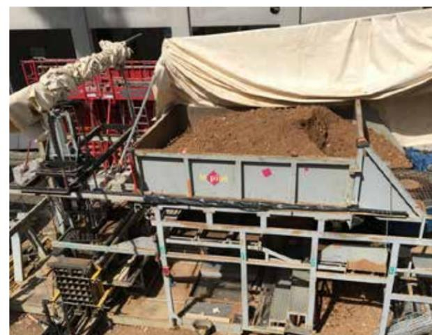
La terre est assemblée en blocs sur le chantier-même.
