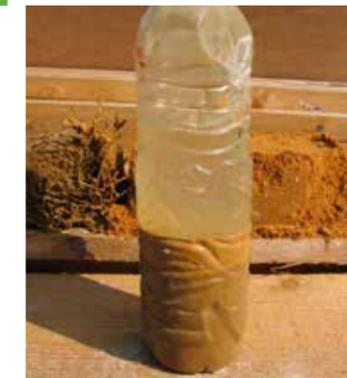
En Limousin, pour savoir si la terre est apte à la construction, on remplit une bouteille de terre bien mouillée et on attend la décantation. En dessous de l'eau, l'argile, très fine et de couleur différente, surnage au dessus des parties sableuses. Si la proportion argile/ sables est de 15% environ, la terre est bonne à maçonner.
