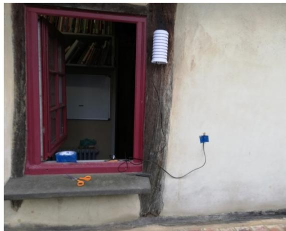
Sonde et abri météo pour mesures sur mur en torchis léger à Puisieux-en-Bray
