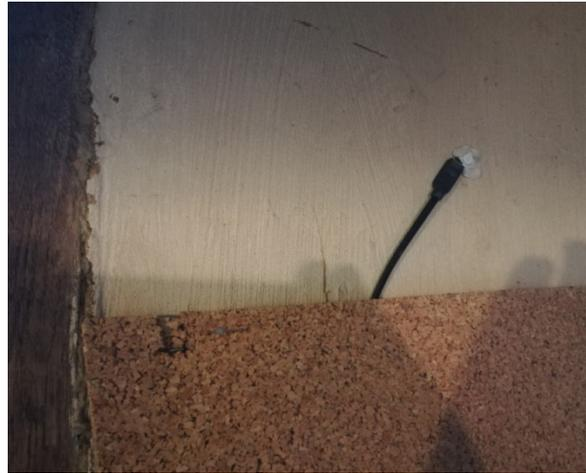
Sonde de mesure de température et humidité relative placée en face intérieure du mur
