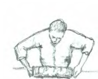
Illustration 30: Pose enroulée :Préfabrication d'andouilles, fuseaux, fusées ou quenouilles constitués de palançons ou barreaux enrobés de torchis sous forme de nappes ou de torches enroulées en spirales, souvent sur table.
