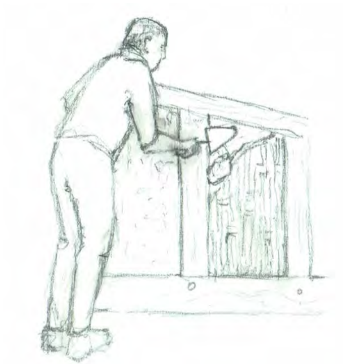
Illustration 27: Pose bourrée ou plaquée : sur un lattis ou sur un clayonnage (espacement inférieur à 4 cm). A la main ou avec un outil (truelle, taloche en bois). Finition par pression verticale. Les deux parements ne sont pas exécutés en même temps. La surface intérieure gagne à être garnie en premier, car elle bénéficie alors d'une ventilation naturelle qui lui assure un séchage plus rapide.
