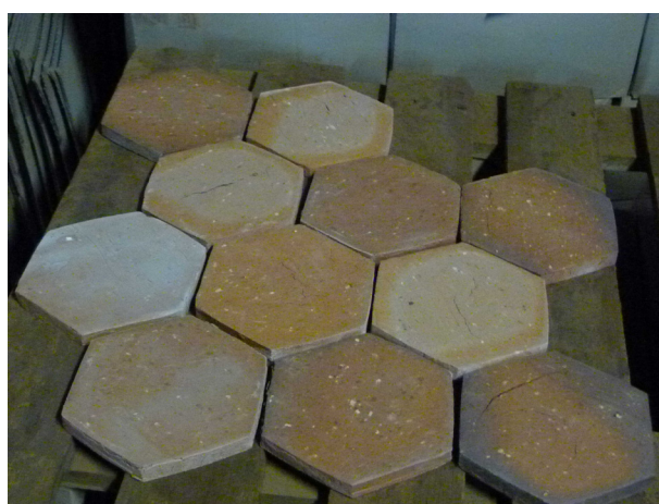
Les carreaux après cuisson
