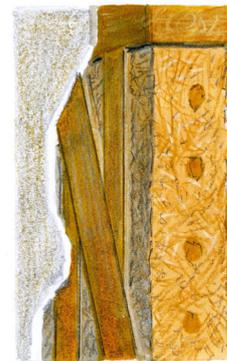
*mur en pan de bois et torchis enduit à la chaux*
